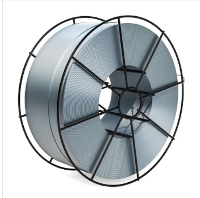
“金属粉型”药芯焊丝的焊接工艺性能类似于实芯焊丝，其熔敷效率和抗裂性能优于“药粉型”焊丝。粉芯中大部分是金属粉（铁粉、脱氧剂等），还加入特殊的稳弧剂，可保证焊接时造渣少、效率高、飞溅小、电弧稳定，而且焊缝扩散氢含量低，抗裂性能得到改善。药芯焊丝的截面形状对焊接工艺性能与冶金性能有很大影响。根据药芯焊丝的截面形状可分为简单的O形和复杂断面的折叠形两类，折叠形又可分为梅花形、T形、E形和中间填丝形等。药芯焊丝适于自动或半自动焊接，直流或交流电弧均要。
